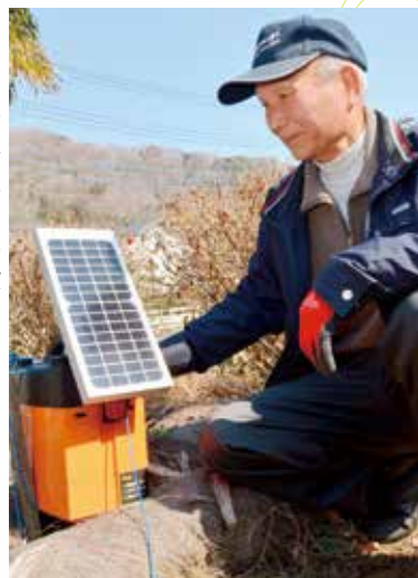
ソーラーパネルを使い電気柵を稼働
